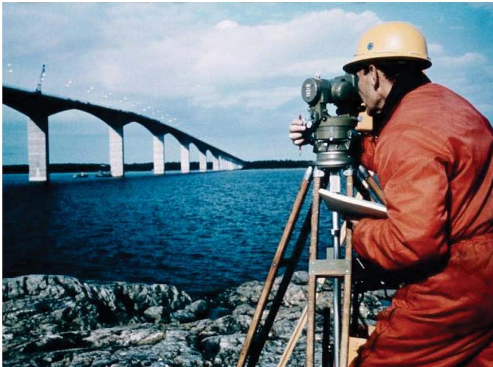
© Bestimmung eines Höhenfixpunktes auf der Ölandbrücke in Schweden mit dem Präzisionstheodolit DKM3 von Kern, 1973. © SMA
