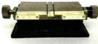
Abb. 4: Der Tastapparat, ein psychotechnisches Gerät zur Messung des räumlichen Feintastgefühls.
