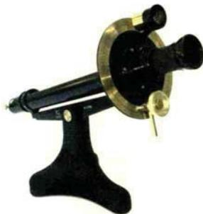
Abb. 3: Das Polarimeter, ein medizinisches Analysegerät zur Bestimmung von Zucker und anderen optisch aktiven Stoffen in Flüssigkeiten.
