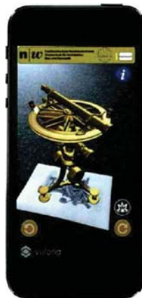
Abb. 3: Die Smartphone-App zeigt den Borda-Kreis über dem Bild-Marker dargestellt (Berchtold & Pünter, 2018).
