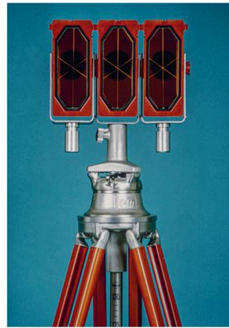
Reflektoren für den Distanzmesser DM 500 von Kern, 1975.
